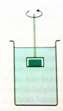
(d) Rotating disc method Static disc method
